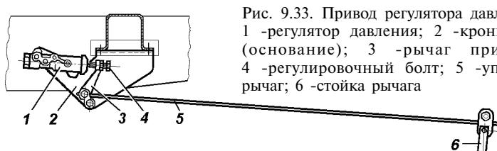
Рис. 9.33. Привод регулятора давления:
