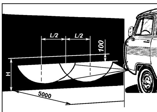
Рис. 9.42. Разметка экрана для регулировки противотуманных фар:
