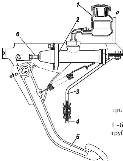
Рис. 9.13. Привод главного цилиндра выключения сцепления:
