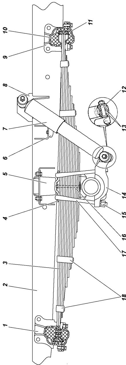
Рис. 9.20. Передняя подвеска автомобиля без АБС:
