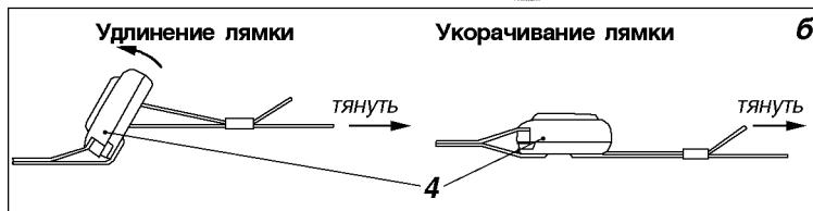
Рис. 3.7. Ремни безопасности салона автомобиля УАЗ-390995, УАЗ-390945: 1 -язычок; 2 -замок; 3 -кнопка замка; 4 -регулятор поясного ремня
