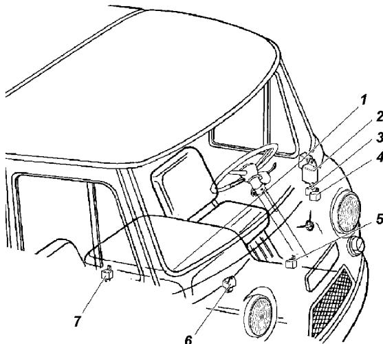
Рис. 9.37 Расположение реле и блока предохранителей
