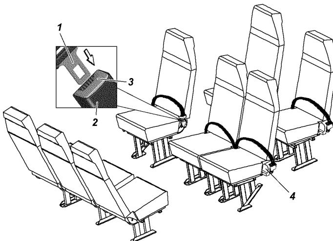
Рис. 3.6. Ремни безопасности салона автомобиля УАЗ-220695: 1 -язычок; 2 -замок; 3 -кнопка замка; 4 -инерционная катушка
