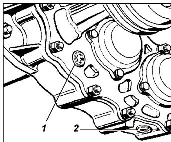
Рис. 9.15. Пробки раздаточной коробки:
