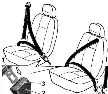
Рис. 3.5. Ремни безопасности: 1 -язычок; 2 - замок; 3 -кнопка замка
