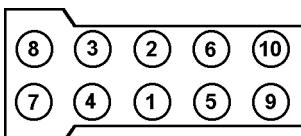
Рис. 9.1. Последовательность затяжки болтов крепления головки блока цилиндров
