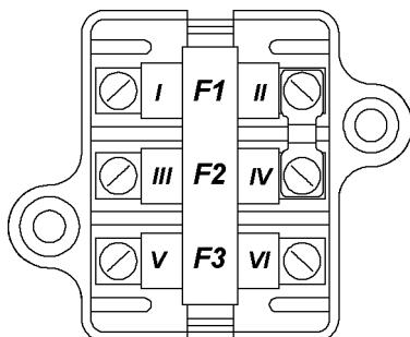
Рис. 9.38 Блок предохранителей F1-F6 -плавкие предохранители (см. таблицу)
